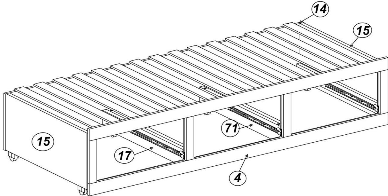
7. На панелях боковых **15** с помощью винтов 6x30 закрепить планки под направляющие **16**. Отверстия диаметром 5мм для крепления направляющих смещены к передней кромке планки. После установки планок должна получиться пара боковин: левая и правая. На нижней кромке боковой панели **15** шурупами 4x13 закрепить колесные опоры
