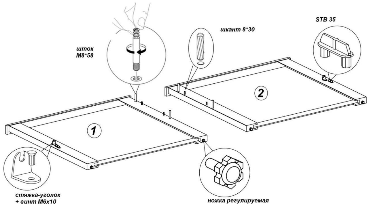
2. На спинке **3** в отверстия диаметром 35мм установить стяжку Spiral Lock. Установить спинку между двух стоек так, чтобы штоки стяжек и шканты вошли в соответствующие отверстия. Затянуть стяжки при помощи ключа шестигранного.
