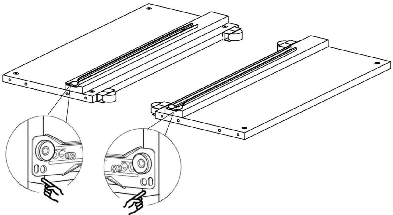
9. На брусе **17** и **71** на нижней кромке установить колесные опоры. С двух сторон шурупами 6,3x10,5 закрепить роликовые направляющие.
