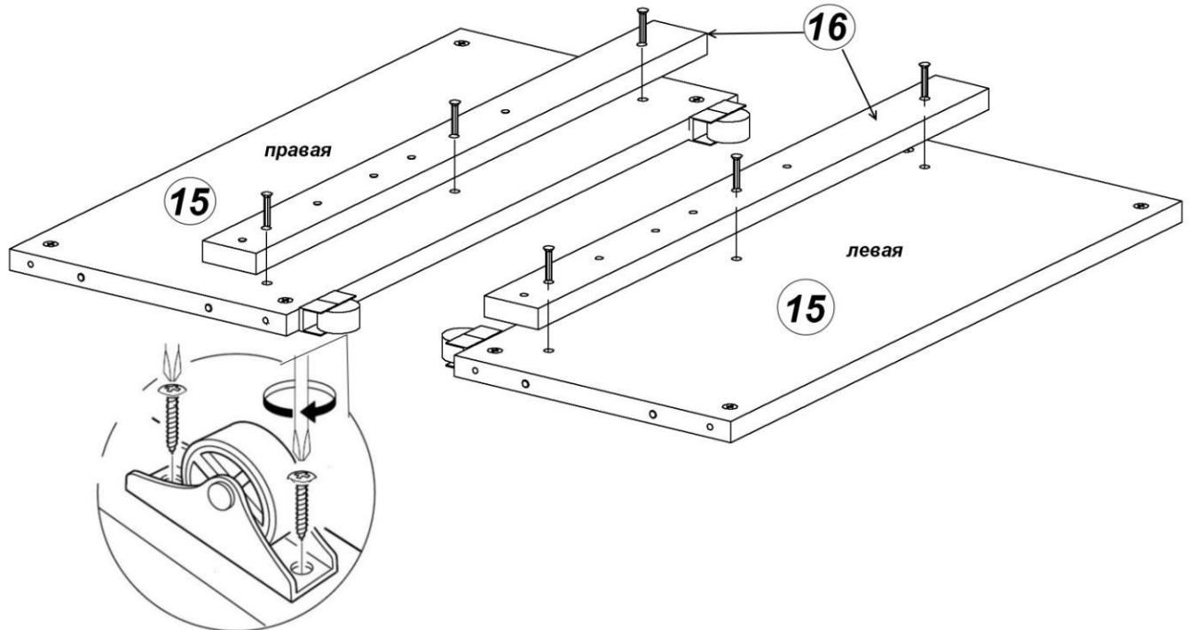
8. Закрепить направляющие при помощи шурупов крепежных 6,3x10,5. Направляющие выступают за переднюю кромку планок.
