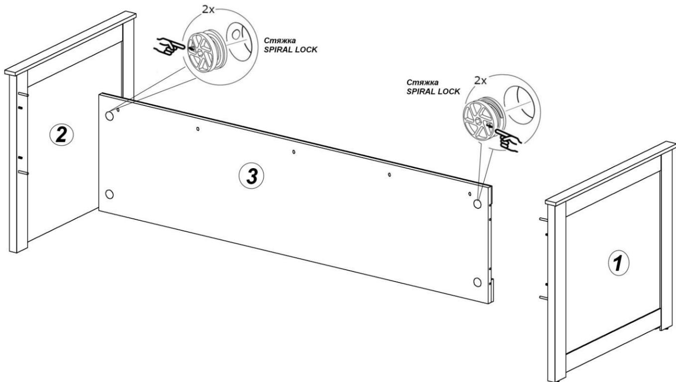
3. В отверстия с установленными муфтами на накладке спинки **10** ввернуть дюбели эксцентриковых стяжек. На спинке в отверстия диаметром 15мм вставить эксцентрики Rastex 15/22. Установить накладку на спинку, затянуть эксцентрики
