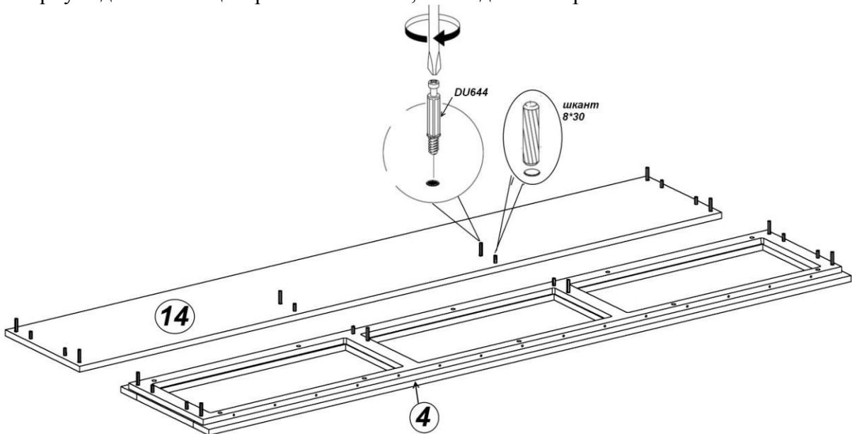
11. Установить на заднюю панель **14** брусы **17**, **71** и панели боковые **15** так, чтобы дюбели стяжек и шканты вошли в соответствующие отверстия. Вставить эксцентрики Rastex 15/22 в отверстия диаметром 15мм. Затянуть эксцентрики.
